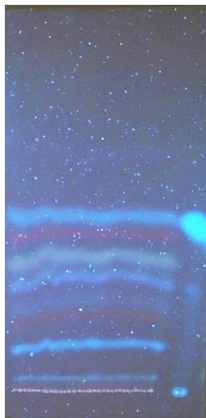
8. ábra Preparatív rétegekromatogram
