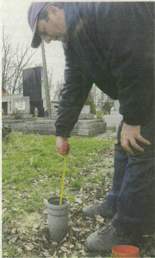
Figyelőkutak vagy próbaásás segítségével ellenőrzik a talajvíz szintjét. FOTÓ: KARNOK CSABA
