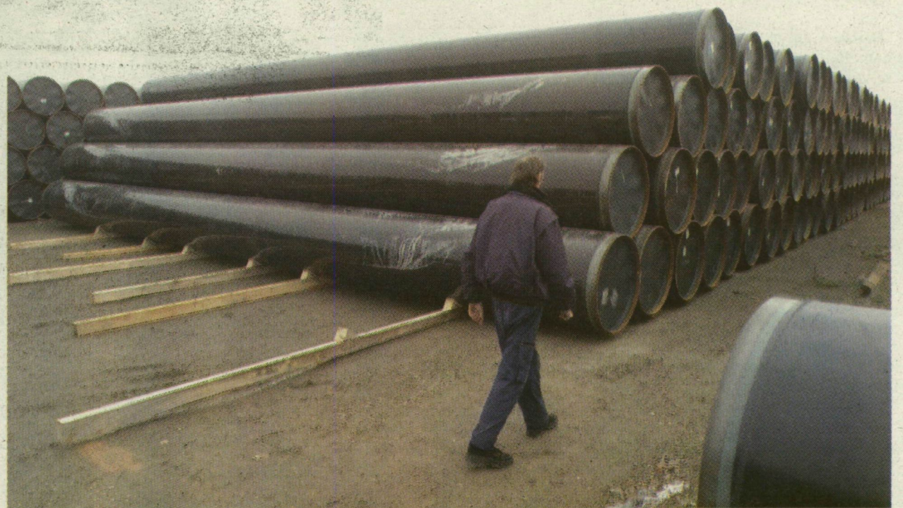
■ EGY-EGY ILYEN MÉTERES ÁTMÉRŐJŰ, 14 MÉTER HOSSZÚ ACÉLKÍGYÓ TÖBB MINT NÉGY ÉS FÉL TONNÁT NYOM
