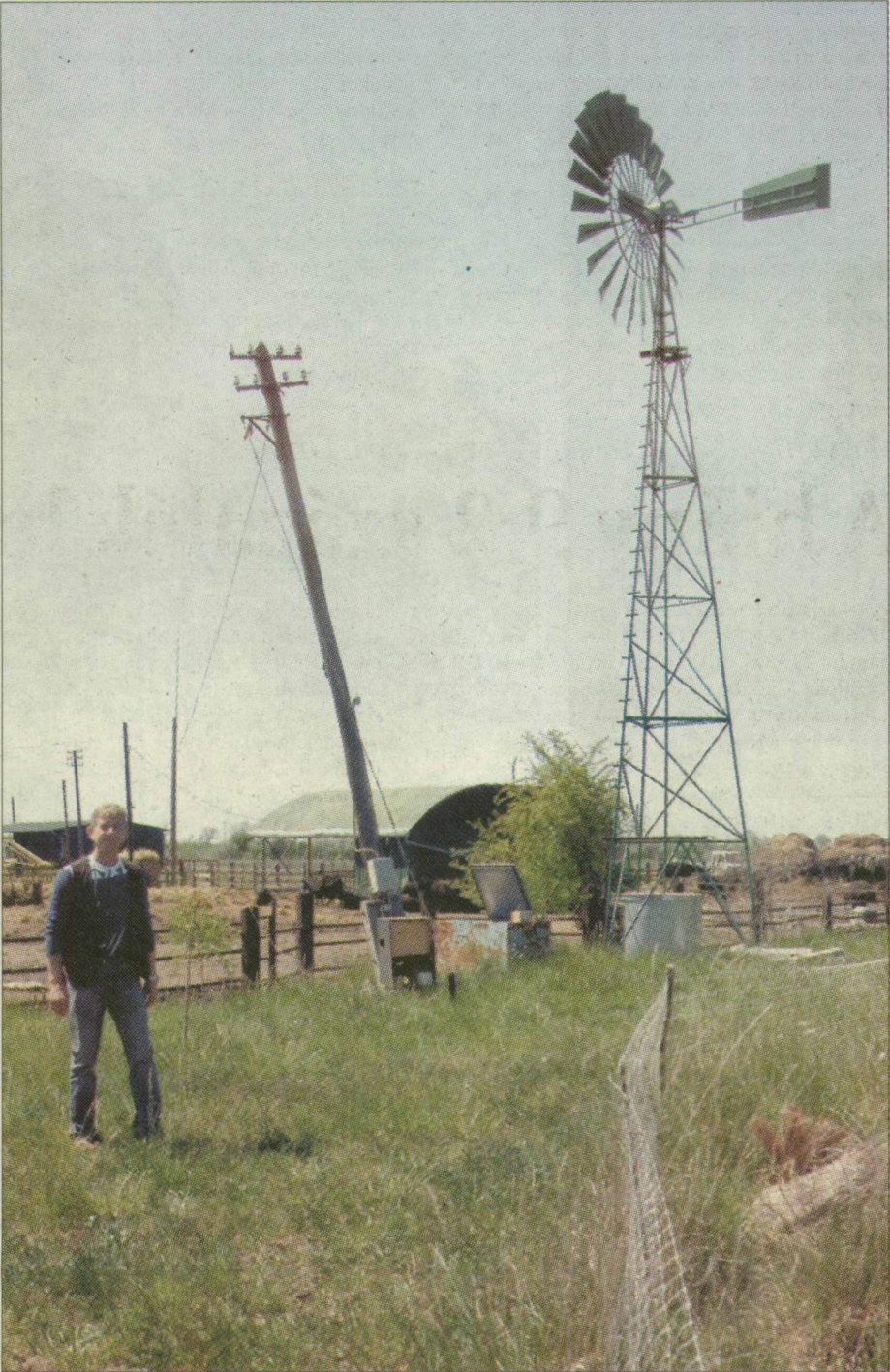
Szőreg mellett szélkerék segítségével emelik ki a földből a vizet
