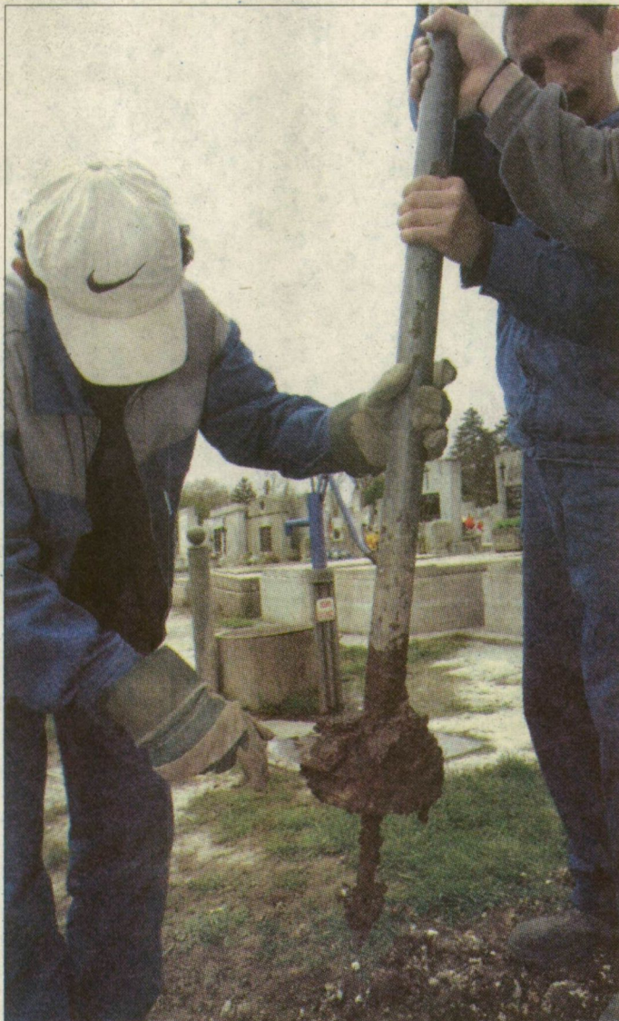
A Dugonics temetőben is próbafúrásokkal ellenőrzik a talajvíz szintjét
