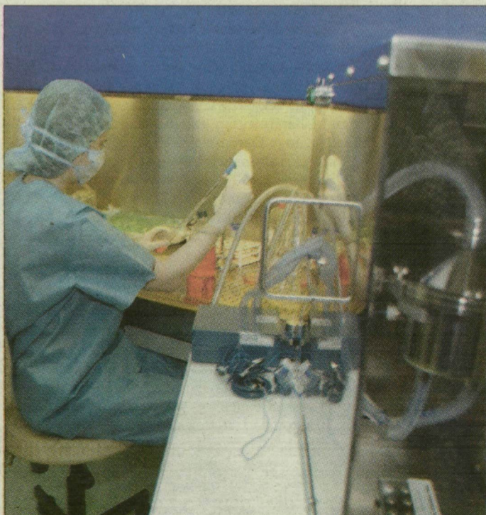
A hasnyálmirigyszigetsejt-izoláló műszer.
