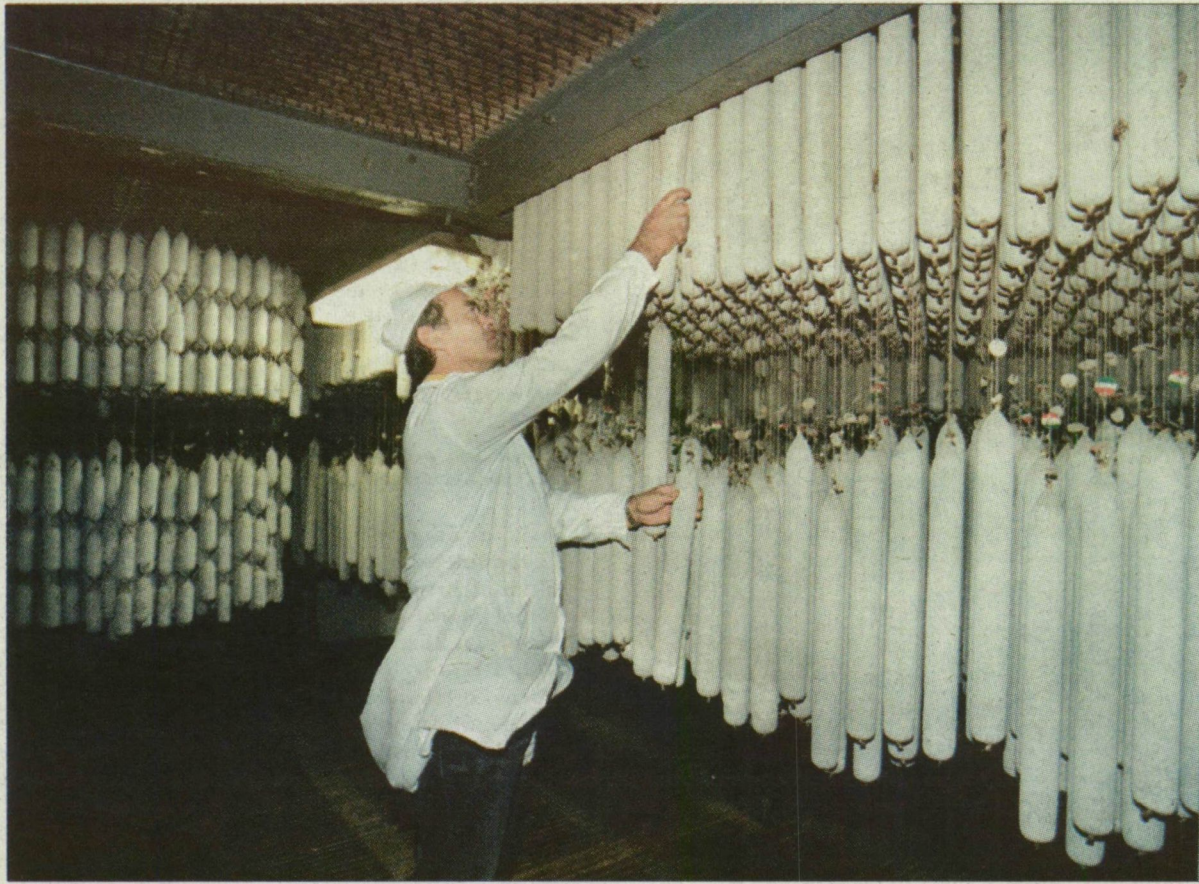
Érlelődő szalámik. Itt a felfüggesztés a gyártástechnológia része. (Fotó: Gyenes Kálmán)
