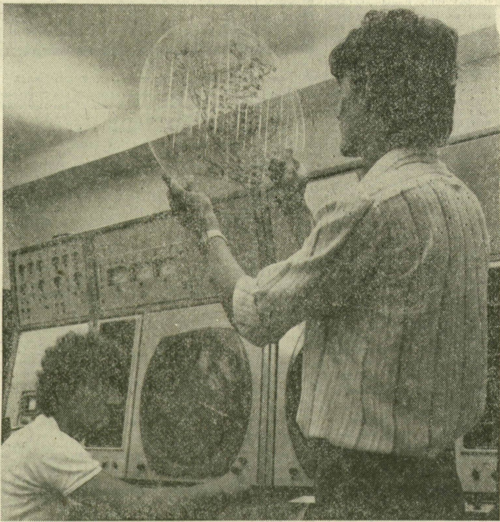
Elkészült és megkezdte méréseit a Szabolcs-Szatmár megyei Napkor község határában az Országos Meteorológiai Szolgálat Központi Előrejelző Intézetének radarmeteorológiai obszervatóriuma. Az intézet feladata, hogy az országos időjárás-előrejelzés és a vízügyi szerek részére adatokat szolgáltatson. A Szovjetunióban kifejlesztett berendezésekkel a felhő-csapadék rendszerekről 2-6 órára, nagy pontosságú előrejelzéseket lehet észlelni, amelyeket az Országos Meteorológiai Szolgálat számítógéppontjában dolgoznak fel. A képen: az obszervatóriumban
