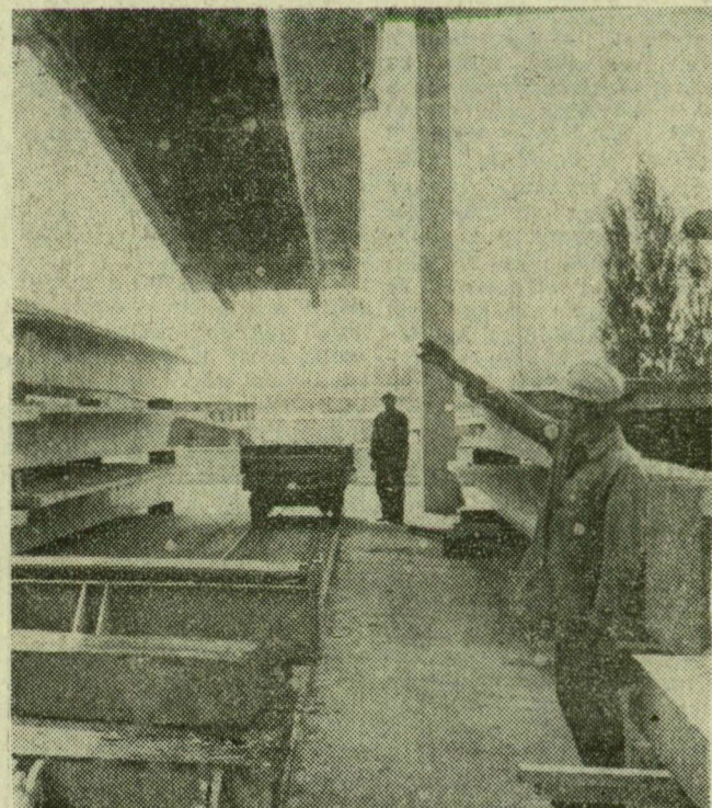
A Beton- és Vasbetonipari Művek dunai városi gyára svéd technológián alapítva megkezdte az építkezés-szerkezetek gyártását. A BMV-TIP rendszerű épületváz- és -falszerkezet széles skálájú felhasználhatóságát biztosítja a sablonok variálhatósága révén. A képen: késztermék raktározása.
