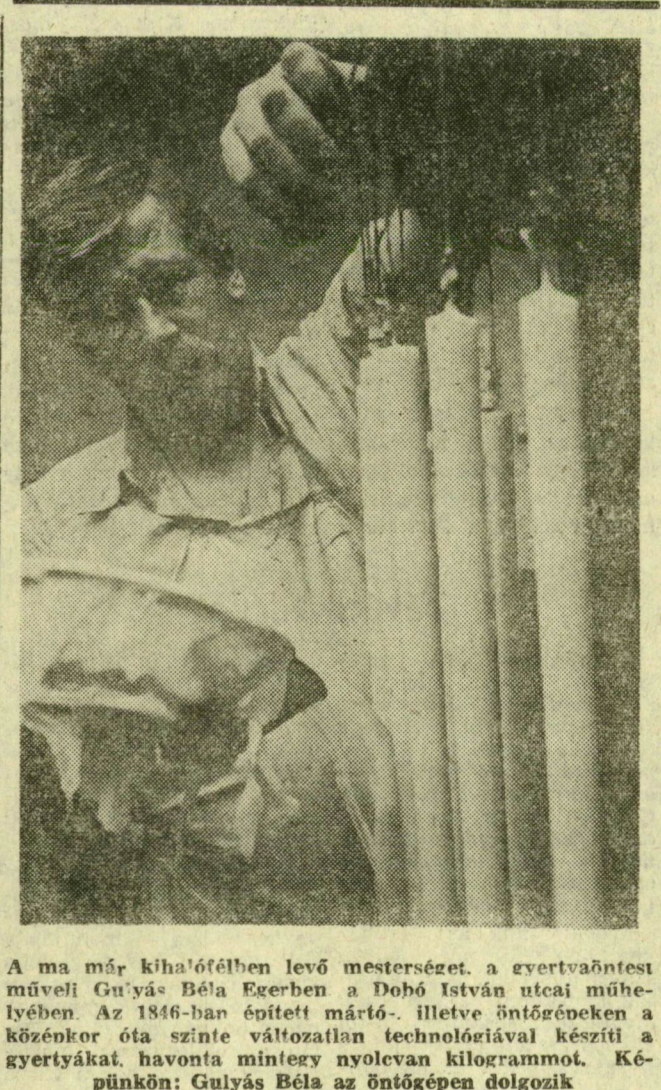
A ma már kiha'ofélben levő mesterséget, a gyertyaöntést műveli Gulyás Béla Egerben a Dobó István utcai műhelyében. Az 1846-ban épített mártó- illetve öntőgépeken a középkor óta szinte változatlan technológiával készíti a gyertyákat, havonta mintegy nyolcvan kilogrammot. Képnél: Gulyás Béla az öntőgépen dolgozik
