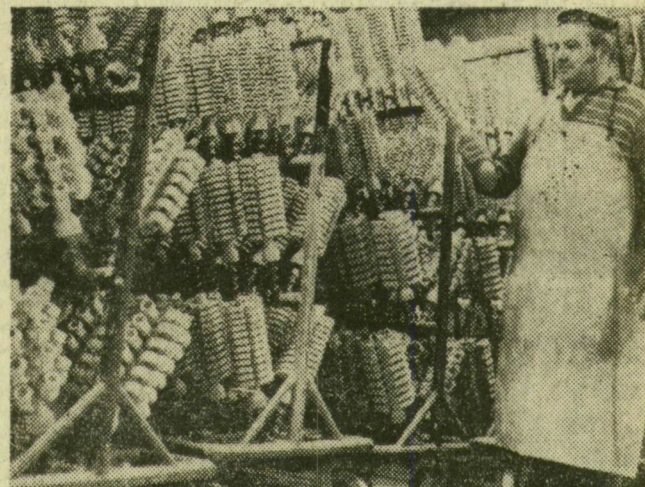
A precíziós öntőben előke szítik a viasz öntőformákat
