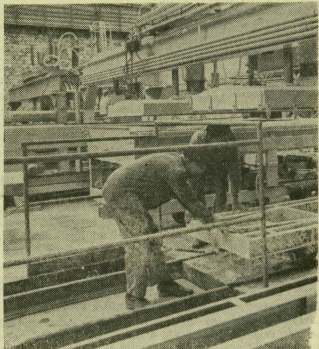
A nyergesújtai új eternitgyárban szovjet és dán technológiai berendezésekkel az idén ötmillió — teljes feltűtás után hétmillió-kettőszáz ezer — négyzetméter azbeszt-eternit lemezt állítanak elő. A 300 méter hosszú és 70 méter széles előregyártott vasbeton gyártósornak két gépsoron már termelnek, a többi gépek szerelése befejezéshez közeledik.
