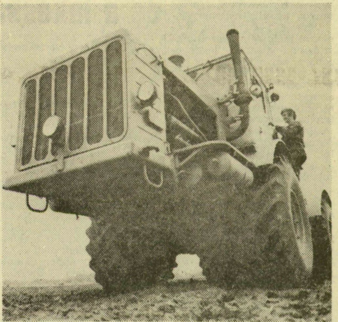
A Lajtahansági Állami Gazdaságba óriás traktorok érkeztek. A K-700-as szovjet, 8 hengeres, 200 lóerős, turboventillátoros óriás gép 10 óra alatt 8 ekével 40 hold szántást végez. E gép előnye, hogy enyhíti a traktoros-hiányt, hiszen egy-egy óriás erőgépet teljesítménye 5-6 hagyományos traktor, illetve traktorost helyettesít.
