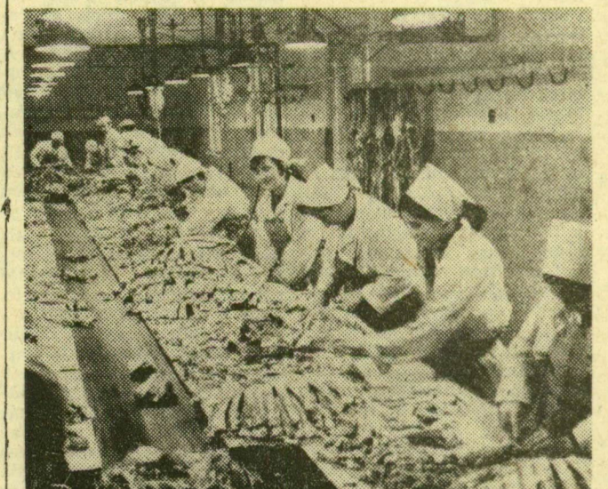
FUTOSZALAGON A HÚS. A szegedi szalámigyárban korszerű körülmények között készítik elő a híres termék alapanyagát, a disznóhúst. Képünk a csontozóüzemben készült, ahol nemcsak késsel, hanem kisgépekkel, szállítószalaggal is felszerelték a csontozókat
